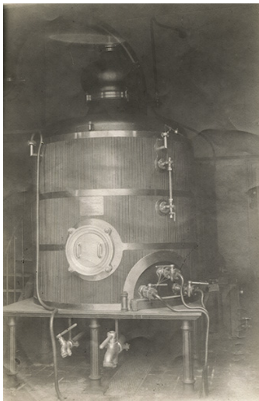
Alambic (distillation d'absinthe), fotogr., s.n., s.d. [début 20e siècle]. 25, Pontarlier, 34-36 rue de Besançon
