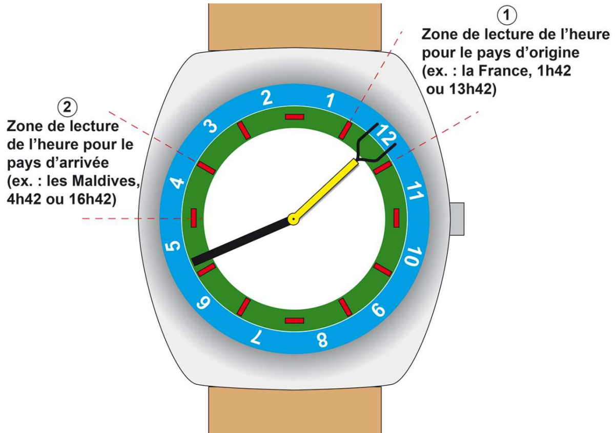
Fig. 2 : Schéma de principe pour l'utilisation de la montre.
