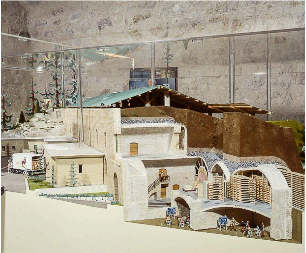
Maquette du fort, coupe sur le bâtiment Cavalier au niveau du porche.
