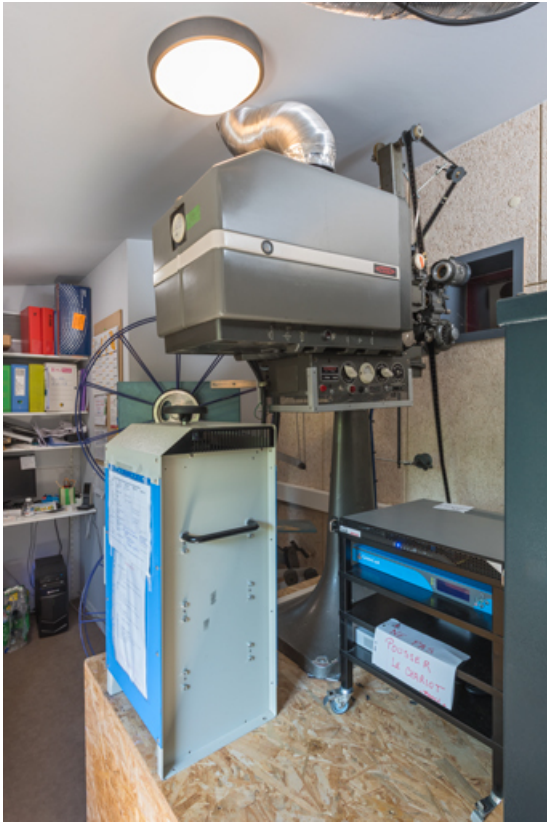
Projecteur Fedi XV T et son redresseur Irem N3-X75DM, depuis l'entrée de la cabine. 71, Anost, 4 place de la Bascule
