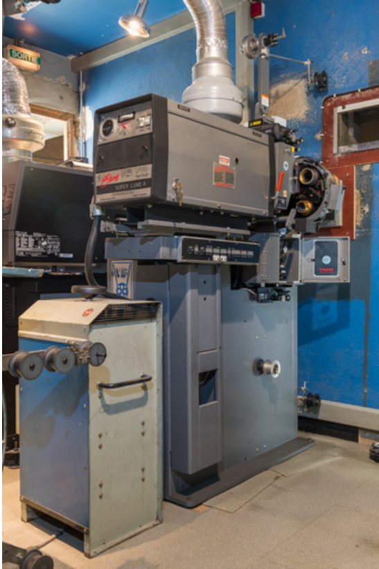
Projecteur Simplex et redresseur Prevost, de trois quarts arrière droit. 71, Tournus, 37 rue de la République
