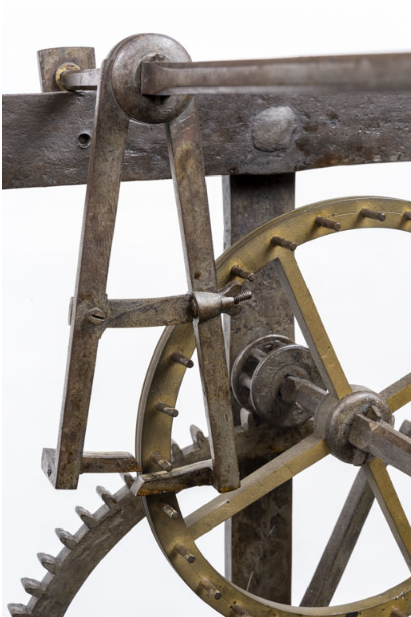
Echappement à chevilles : ancre et roue d'échappement.
