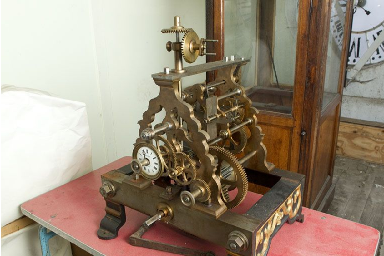
Mouvement : cadran de contrôle et roues dentées.
