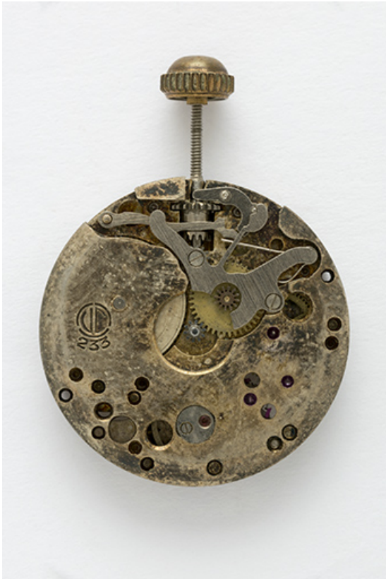
Mouvement Cupillard VC 233 : face côté cadran. 25, Villers-le-Lac
