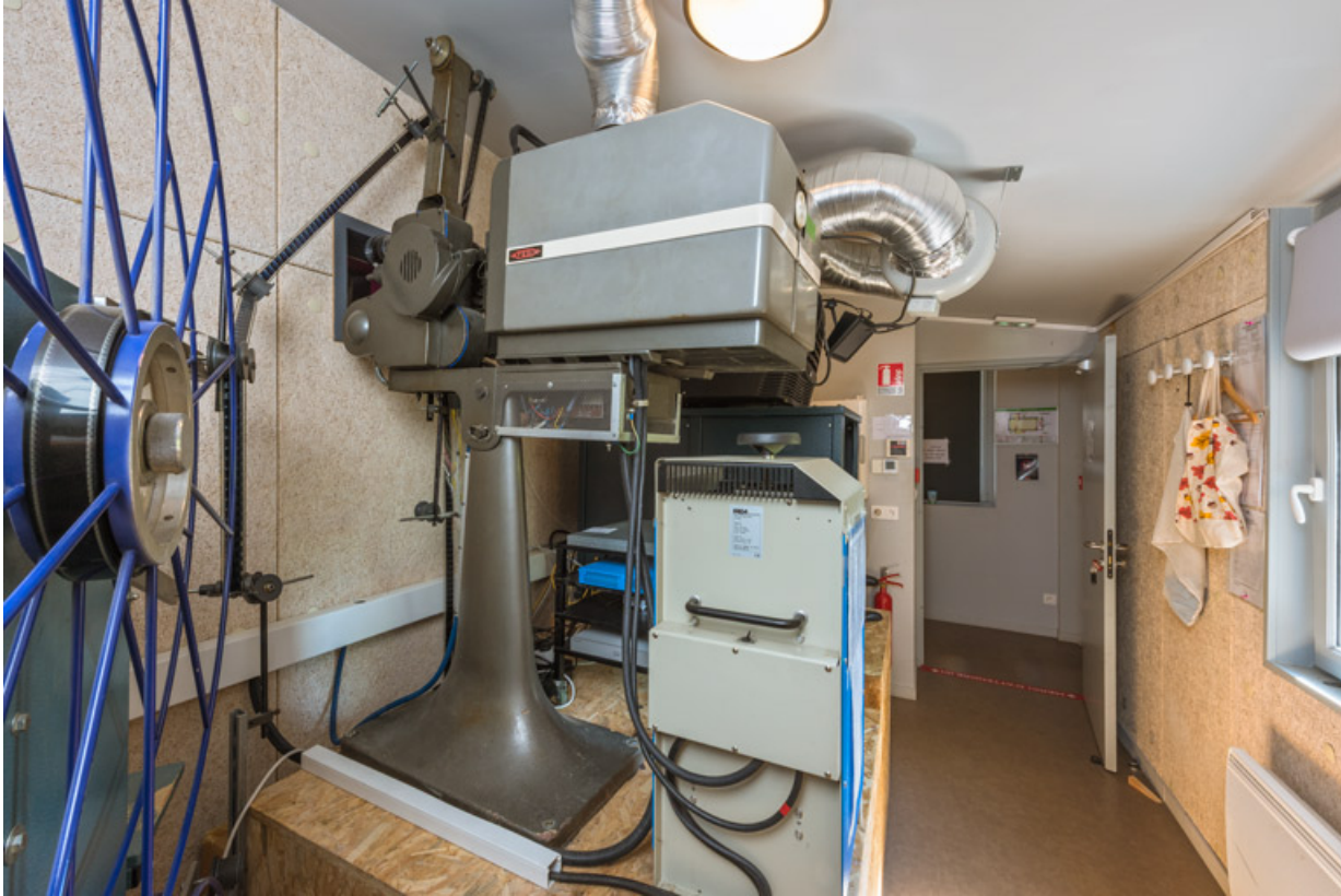
Cabine de projection. Au centre le projecteur argentique Fedi XV T et son redresseur Irem. 71, Anost, 4 place de la Bascule
