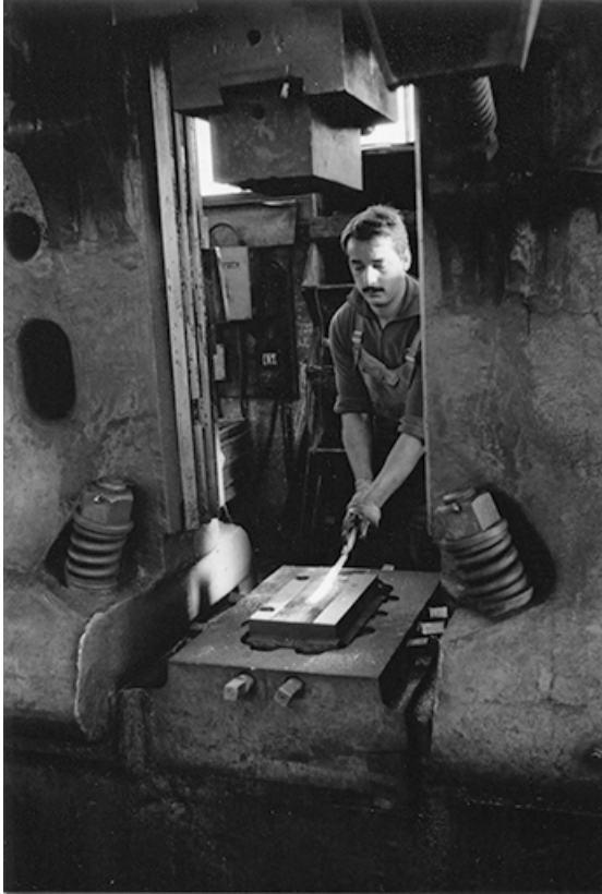
Philippe Parent forge une ébauche avec le marteau-pilon Erie, 1985. 25, Montécheroux, 31-33 rue de Saint-Hippolyte
