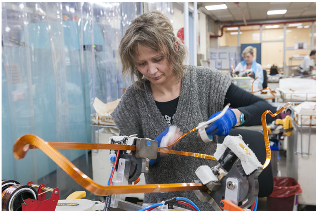
Isolation manuelle des barres de cuivre.
