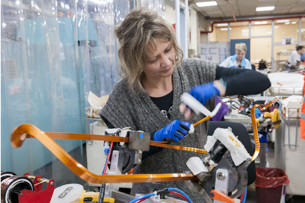
Isolation manuelle des barres de cuivre.
