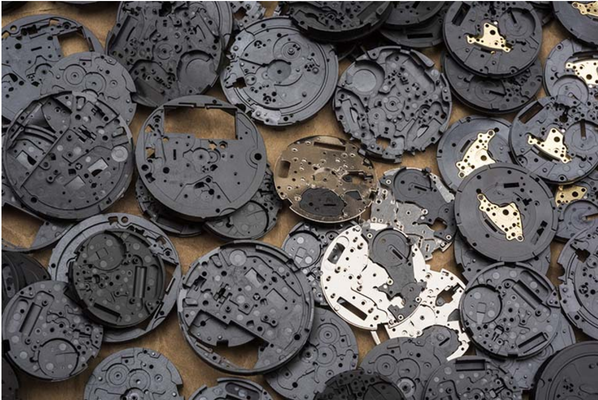
Composants fabriqués à l'usine : platines de montre.
