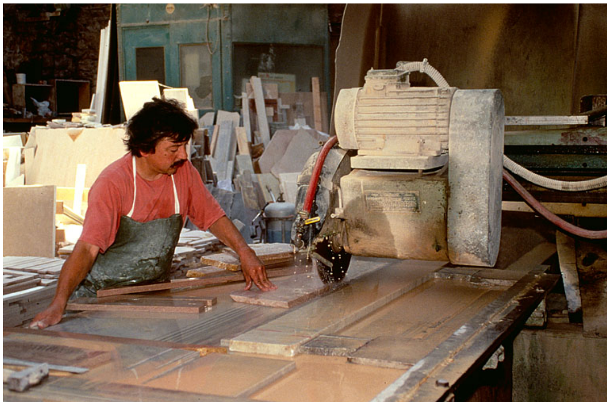
Débitage de plinthes en marbre de Balanod.
