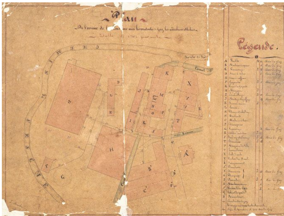
Plan de l'usine de la Casserie avec les conduites de gaz, les réverbères et les becs.
