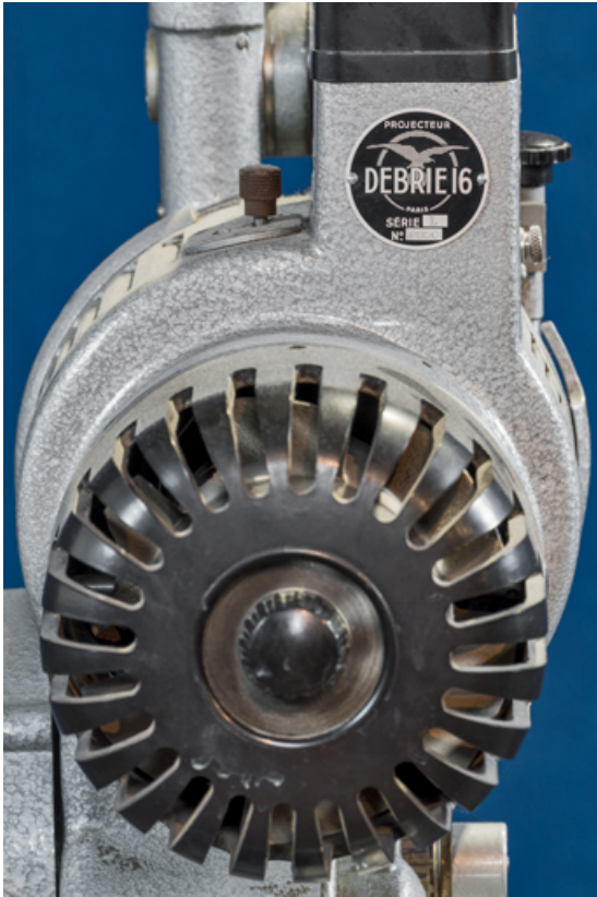
Arrière : moteur électrique et plaque signalétique.
