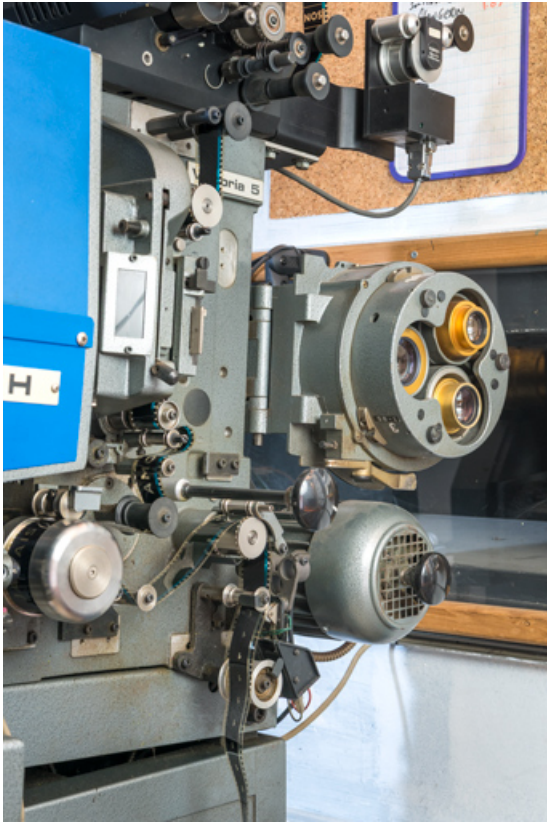
Chrono et tourelle porte-objectifs, de trois quarts. 71, Chauffailles, 50 rue Centrale
