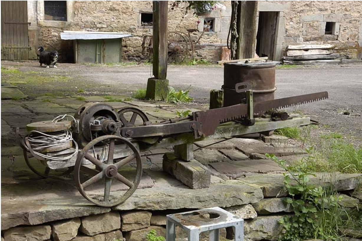
Tronçonneuse artisanale placée sous l'auvent de l'atelier.
