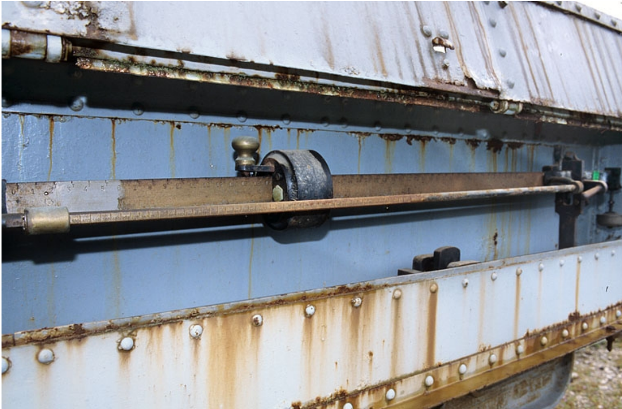
Appareil indicateur : le fléau à la romaine.
