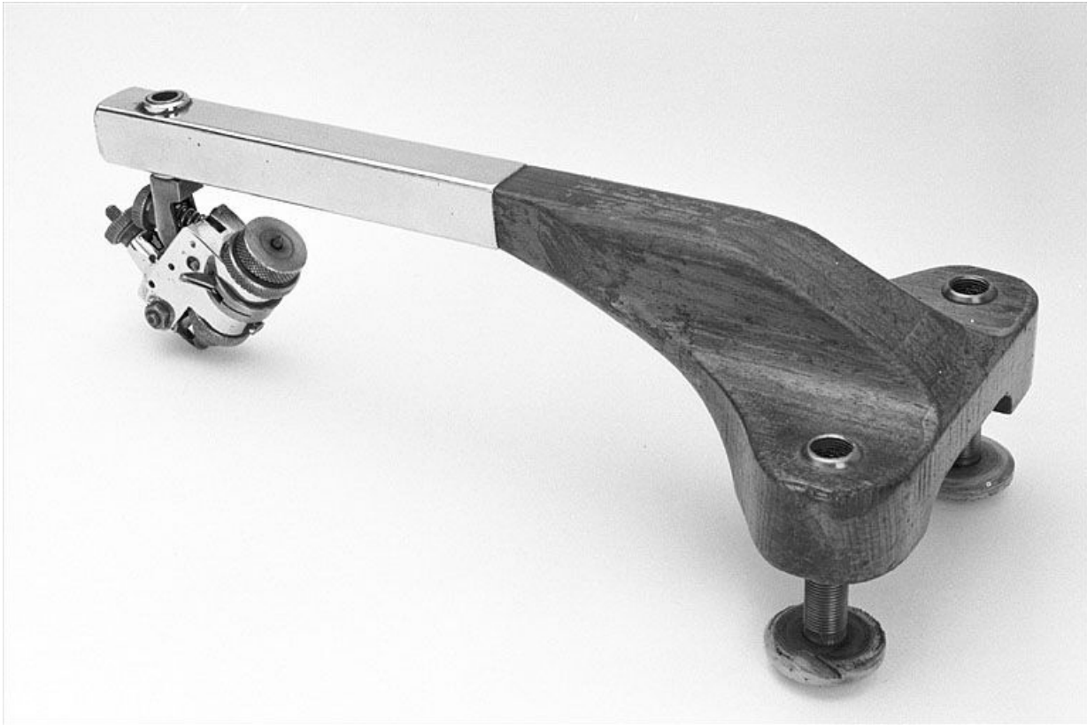
Pince mécanique (tenaille de lapidaire), vue du côté du diamantaire. 39, Saint-Claude
