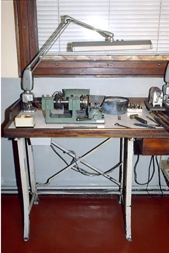
Vue d'ensemble d'une machine à débruter et de son four à résistance. 39, Saint-Claude
