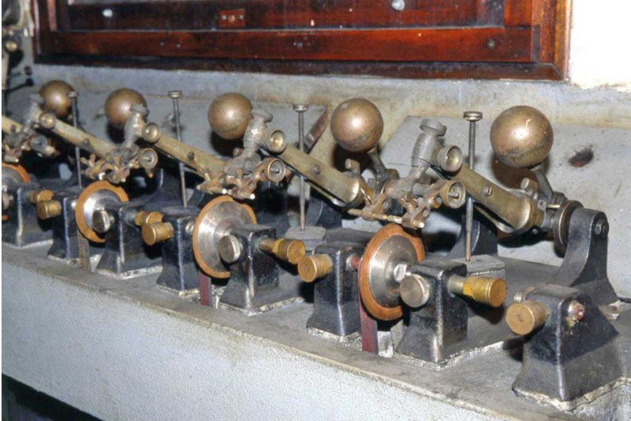
Ensemble de scies. Le contrepoids sphérique et la tige filetée règlent la pression du diamant sur la lame circulaire. 39, Saint-Claude
