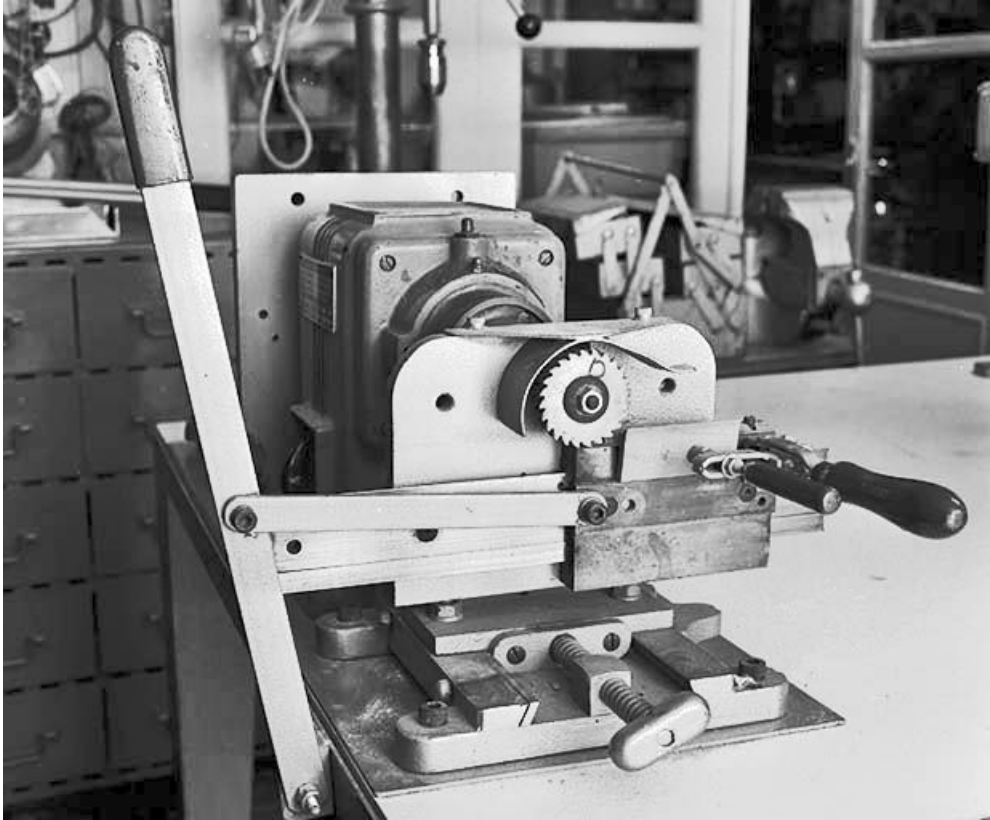
Détail de la fraise (côté fraiseuse).
