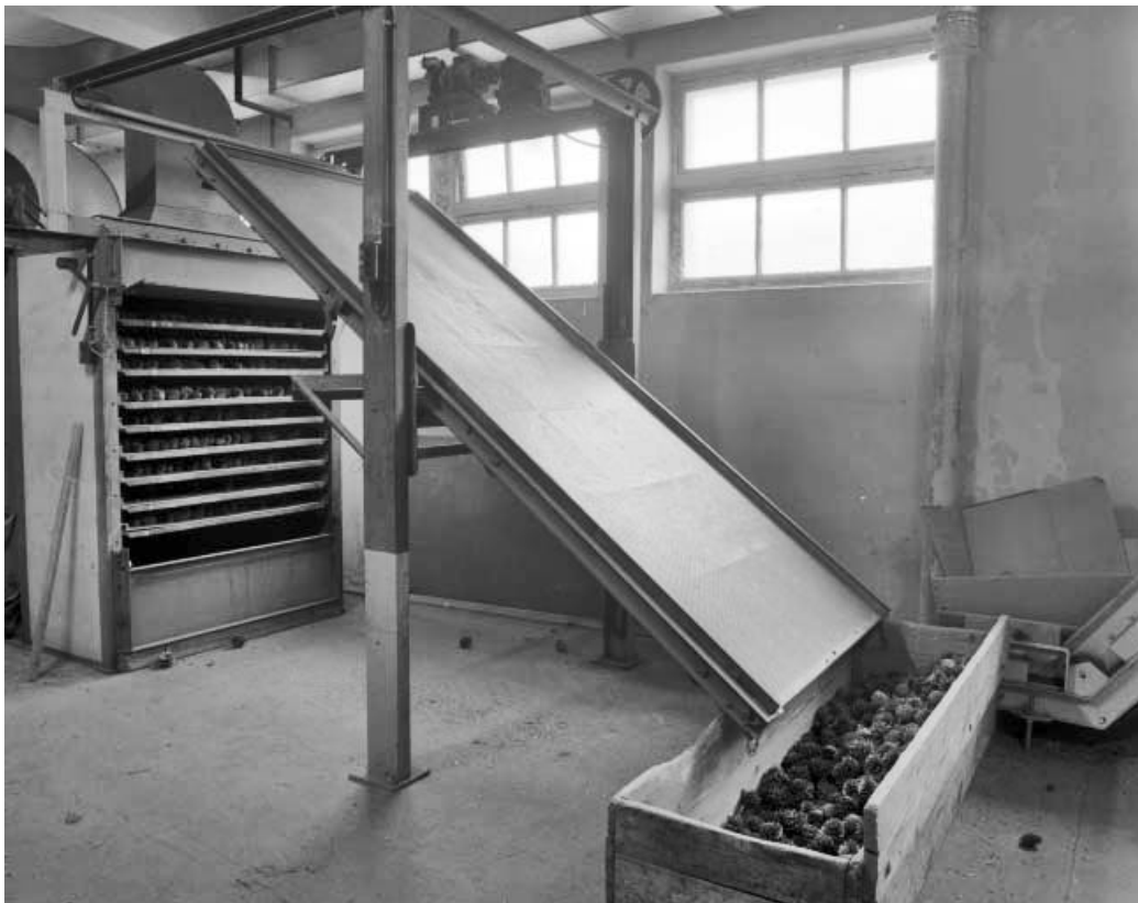
Séchoir ouvert et grille basculée.
