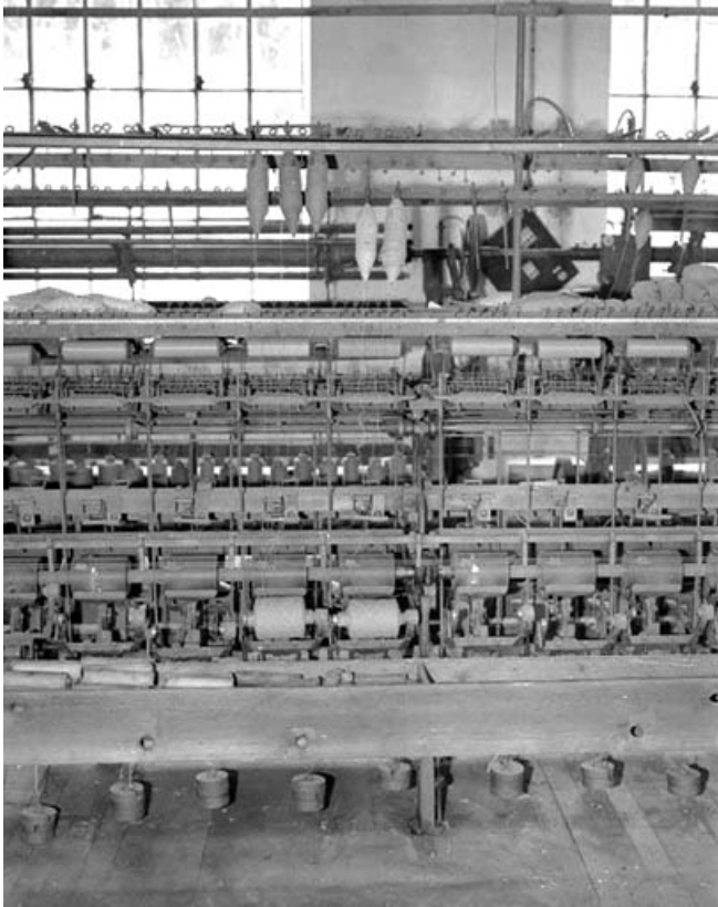
Détail d'une face, montrant 7 bobinots. De haut en bas, ratelier de dévidage à 2 niveaux supportant les bobines, tendeur, système de casse-fil, système de croisement des fils sur le bobinot, tambour moteur et bobinot.
