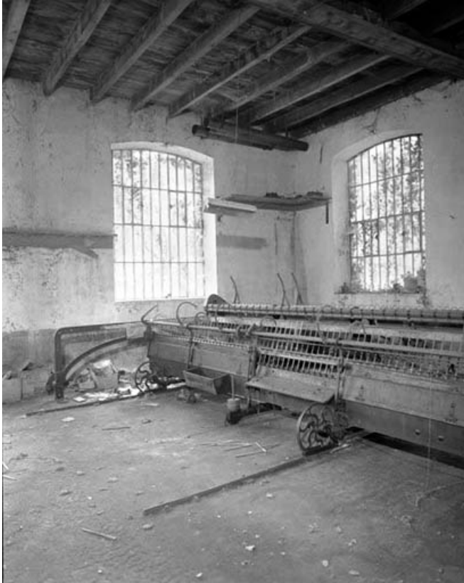
Chariot du module de gauche. Au premier plan, rail de guidage du chariot. Le volet ouvert laisse apparaître le système d'entraînement des broches.
