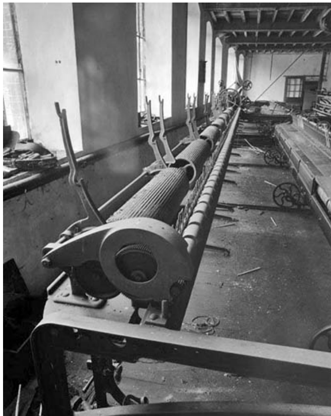
Ratelier du module de gauche. De gauche à droite, supports des cannelles, tambours cannelés et cylindres presseurs (surmontant les cylindres alimentaires non visibles).
