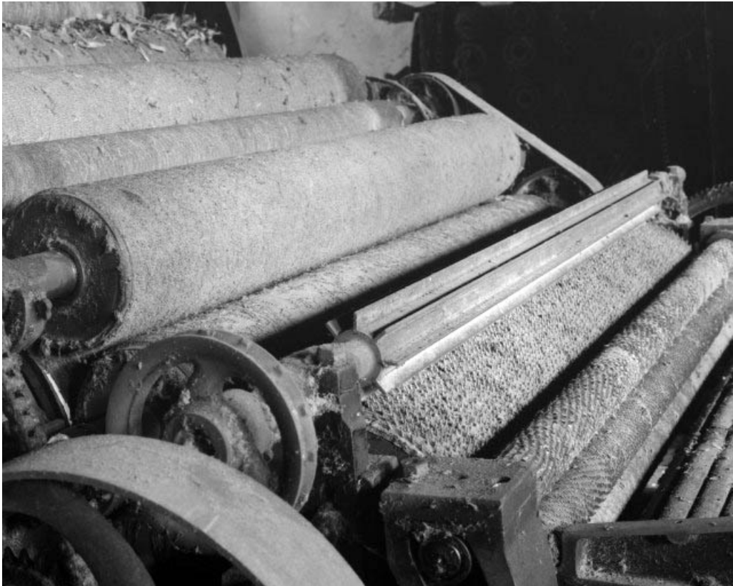
Détail du cylindre briseur. De droite à gauche, rouleaux alimentaires, cylindre briseur puis cylindres cardes de l'avant-train. 39, Balanod, lieudit : sous Roches
