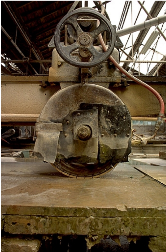
Débiteuse nord : détail de l'organe de sciage.
