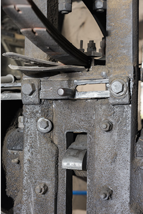
Martinet vertical : la came (avec, au-dessus, la poignée du système d'embrayage et le bas des ressorts). 25, Grand'Combe-Châteleu, 5-9 Pré Rondot
