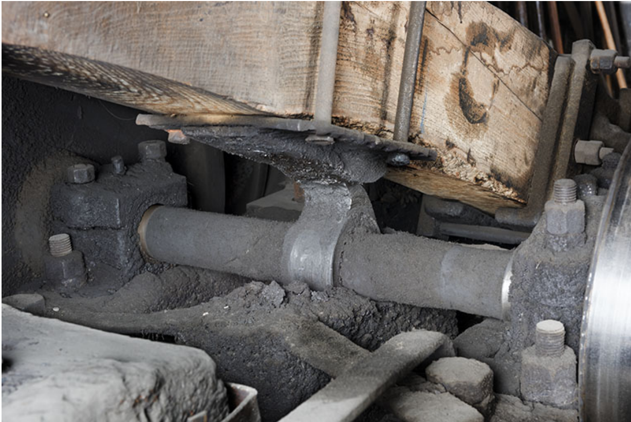
Came en appui contre la plaque de renfort du manche.
