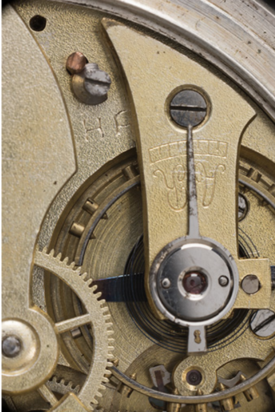
Mouvement : marque du fabricant (HP) et pont du balancier. 25, Villers-le-Lac
