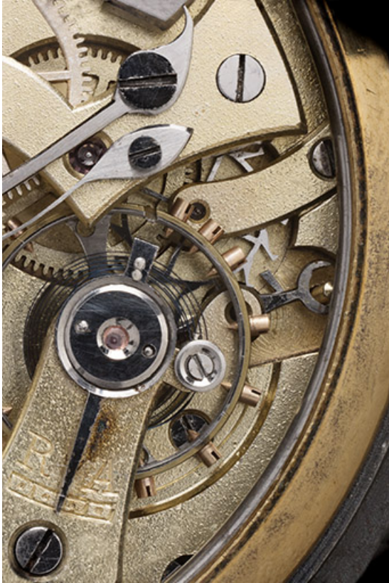
Mouvement : balancier, ancre et roue d'ancre. 25, Villers-le-Lac
