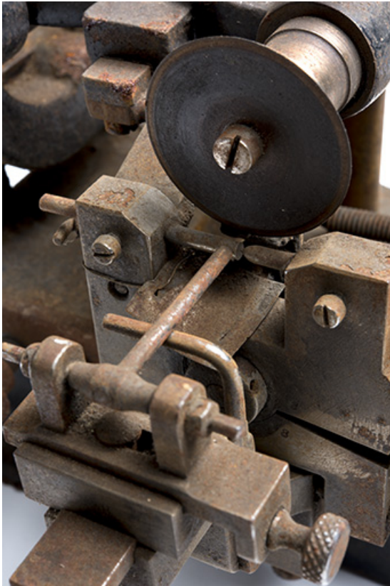
Système de fixation de la roue de cylindre et meule en carborandum, vus en plongée. 25, Maîche, lieudit : Grand Vau
