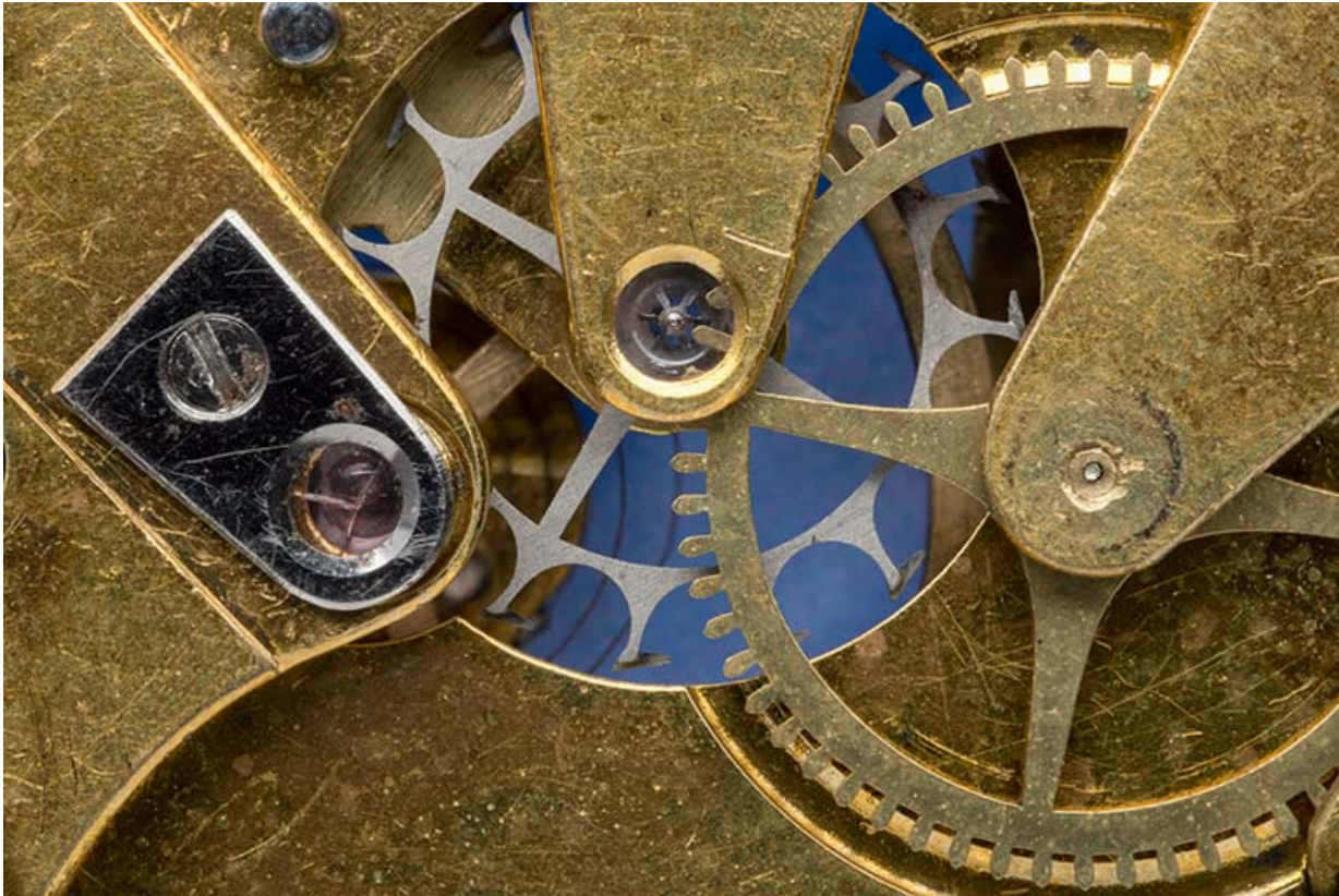
Détail de la face côté cadran : de gauche à droite, rubis servant de contre-pivot au cylindre, roue de cylindre côté pignon, roue des secondes.
