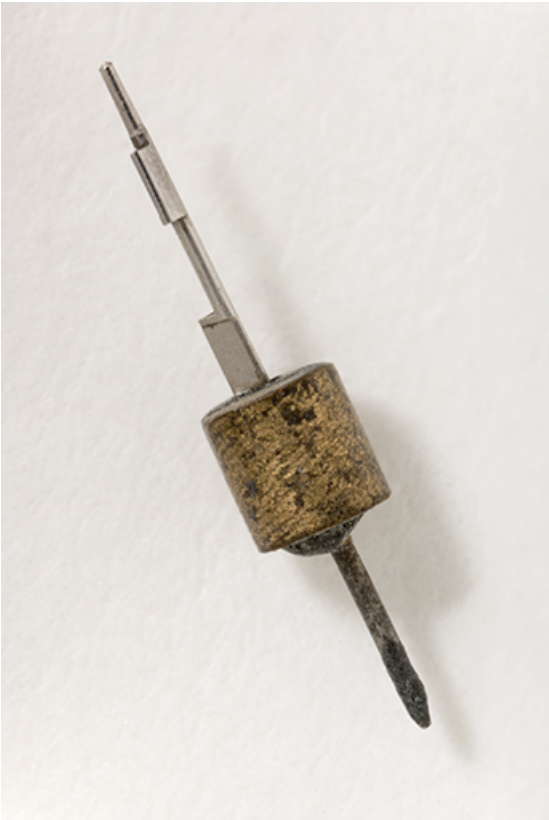
Une verge pour échappement à roue de rencontre. Noter les deux palettes dans la moitié supérieure de l'axe. 25, Charquemont, 12 Rue Neuve
