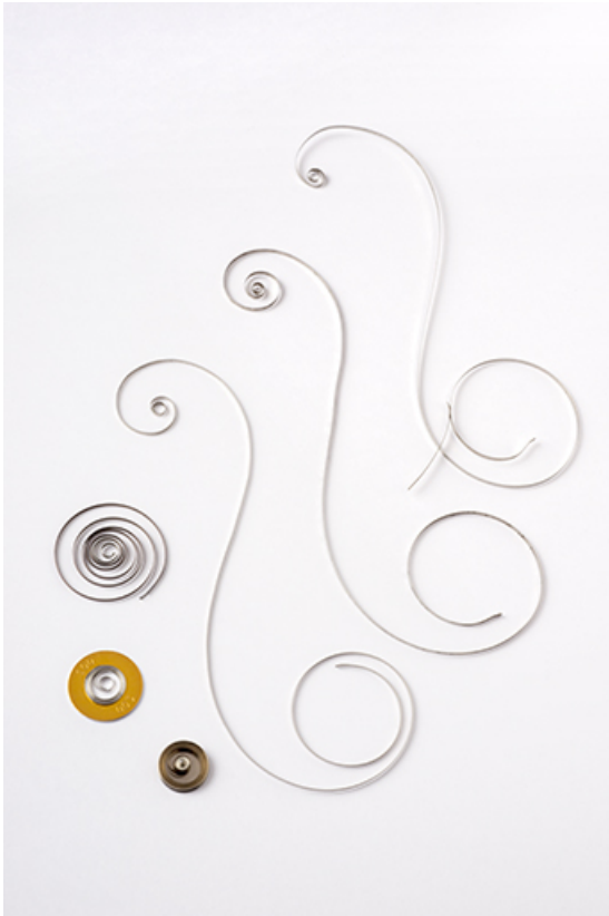
Barillet démonté et ressorts moteurs.
