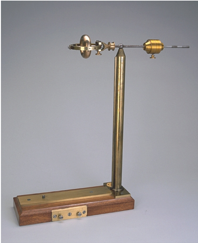
Montage : balance de Fessel et Plucker.
