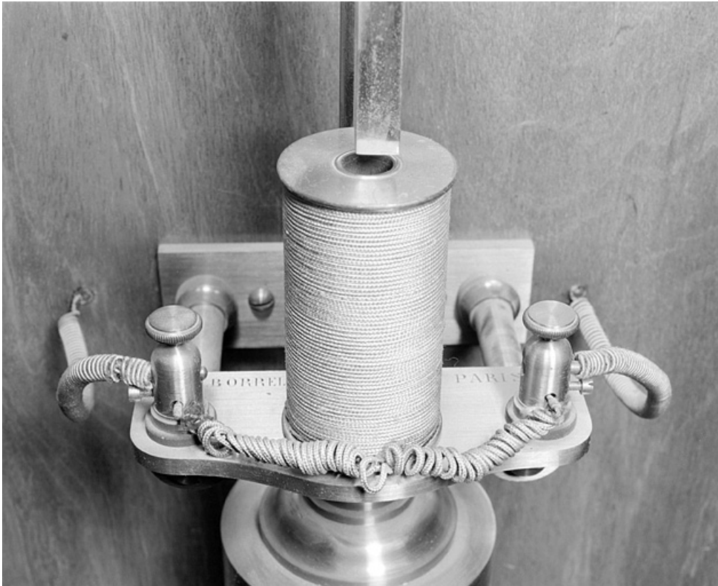
Le mécanisme de remise à l'heure Borrel.
