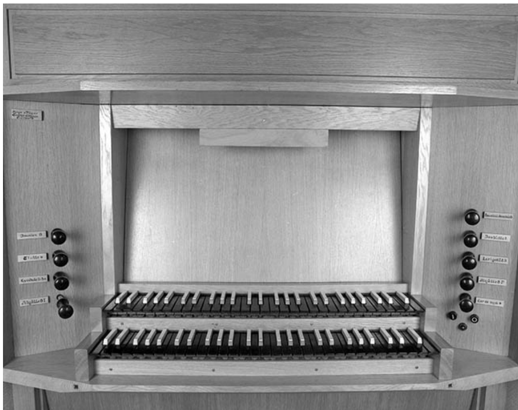
Console vue de face, détail des claviers et tirants de registre.
