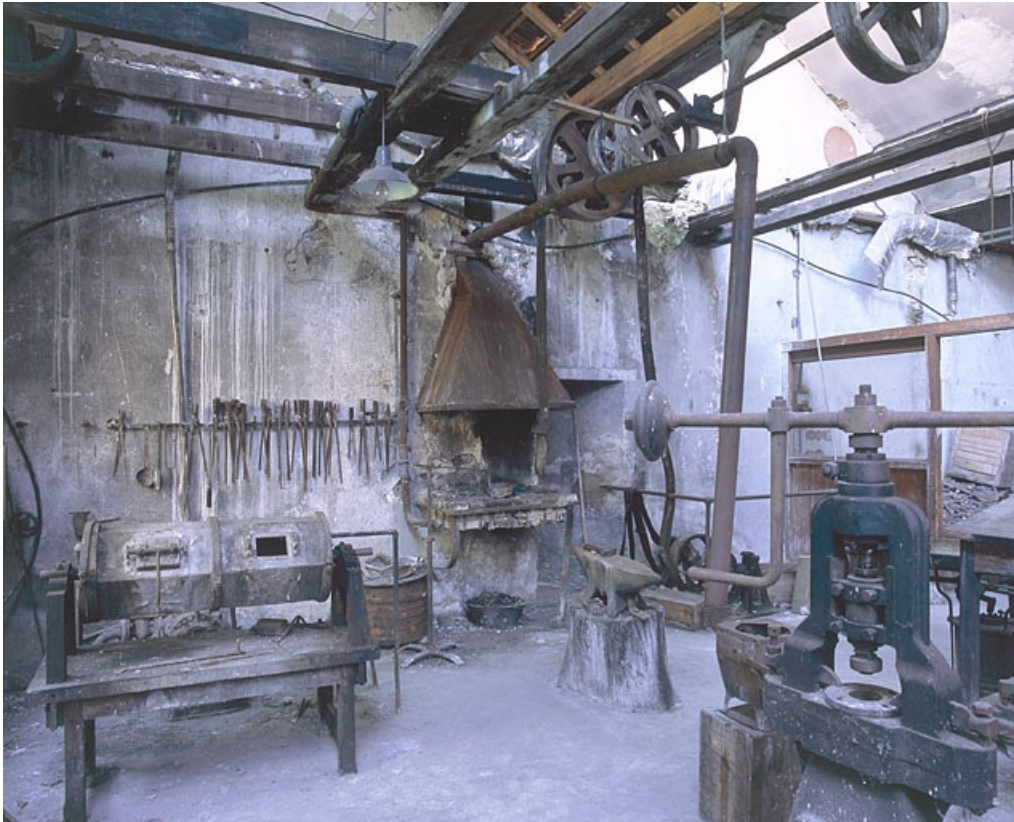
Atelier de mécanique. Départ de la transmission et poulie maîtresse (au fond).
