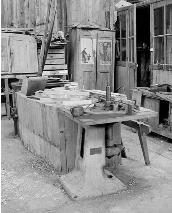
Vue d'ensemble. La caisse en bois dissimule le renvoi de la courroie de transmission.
