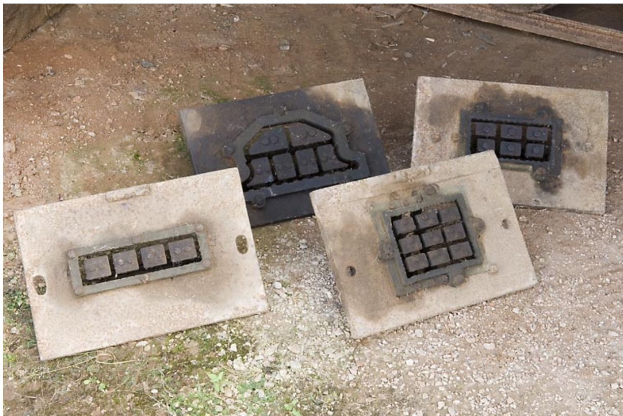
Matrices pour briques de la mouleuse-étireuse.
