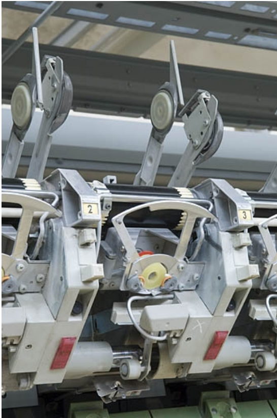
Détail d'une tête de continu à filer Autocoro.
