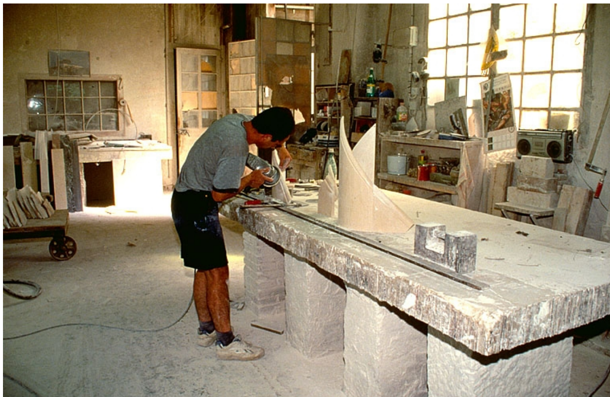
Polissage d'un limon d'escalier.
