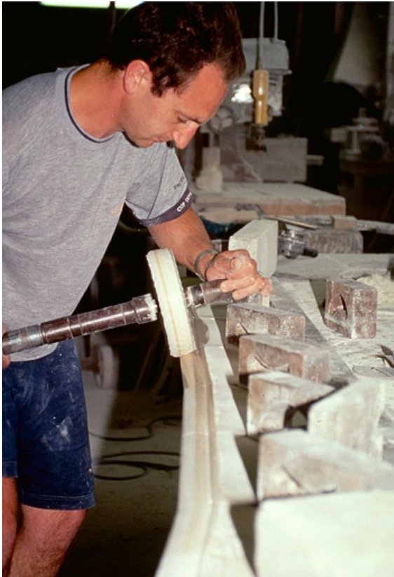
Polissage d'un limon d'escalier.
