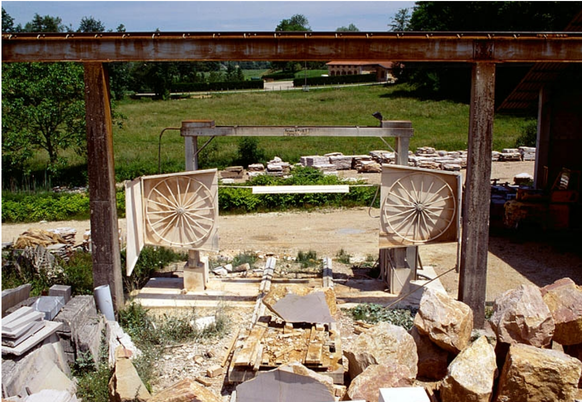
Vue d'ensemble de la scie à fil diamanté.
