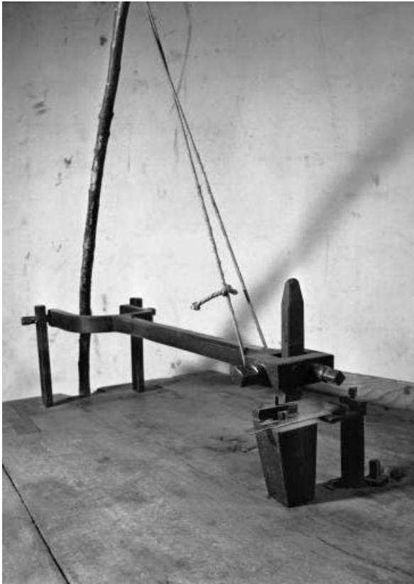
Banc à poinçonner : système de poinçonnage.
