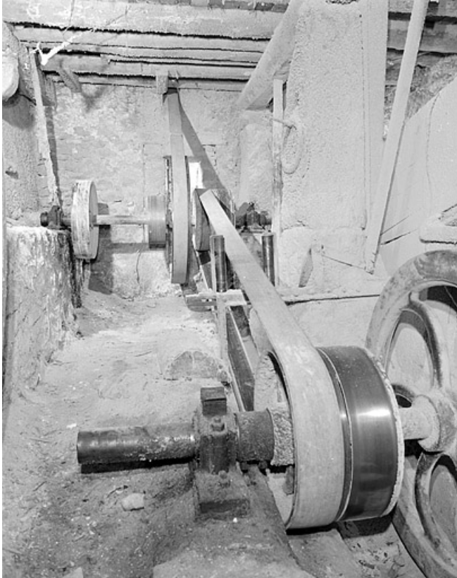
Renvoi de mouvement vers le chassis multiple.
