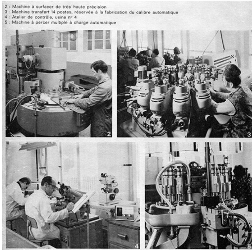
France Ebauches, une haute technicité. [2 à 5. Intérieurs d'ateliers (avec machines à surfacer, à percer et machine transfert), celui de contrôle dans l'usine Anguenot de Villers-le-Lac (vue n° 4)], 1970.
