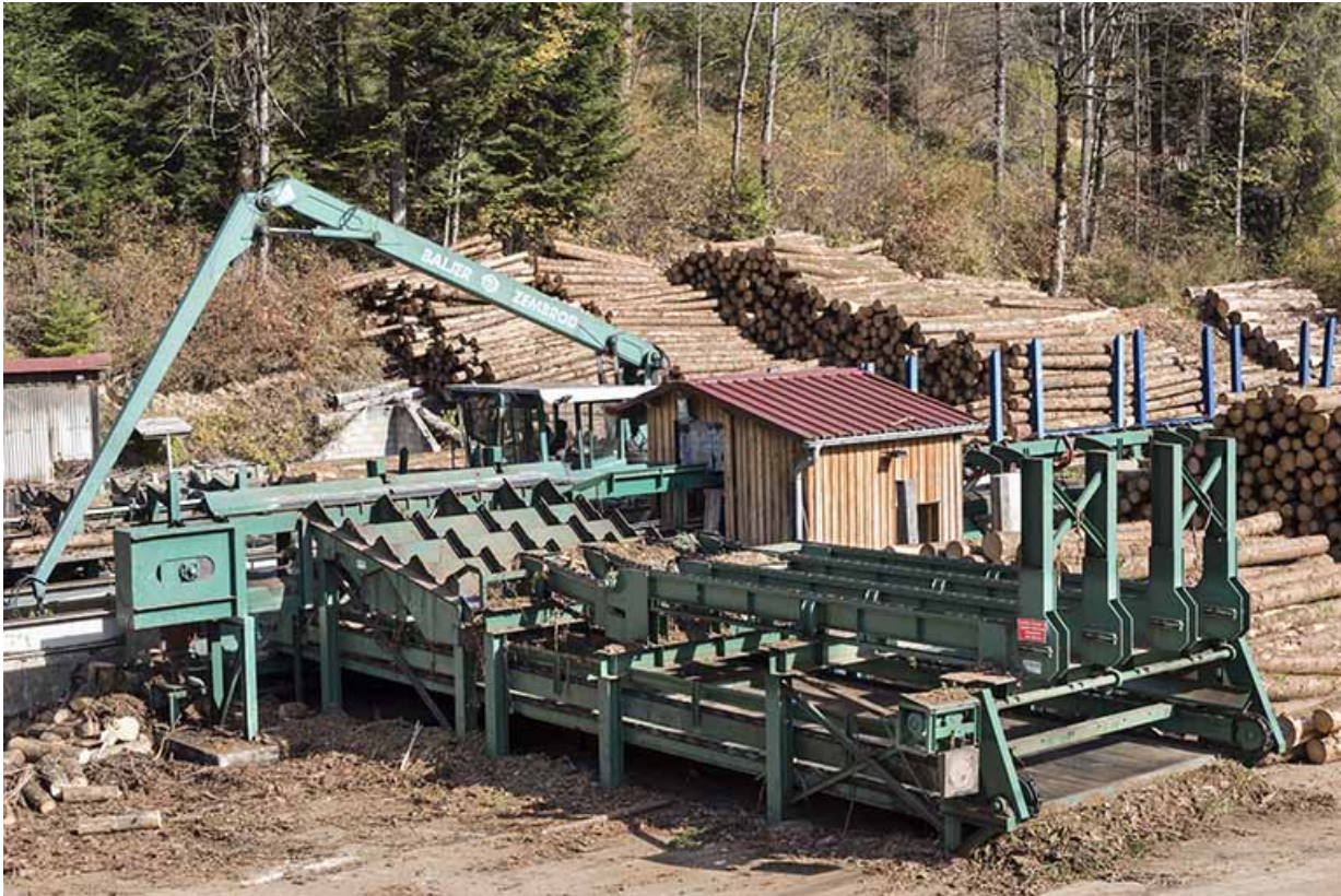
Chariot de tronçonnage Baljer Zembrod et écorceuse.
