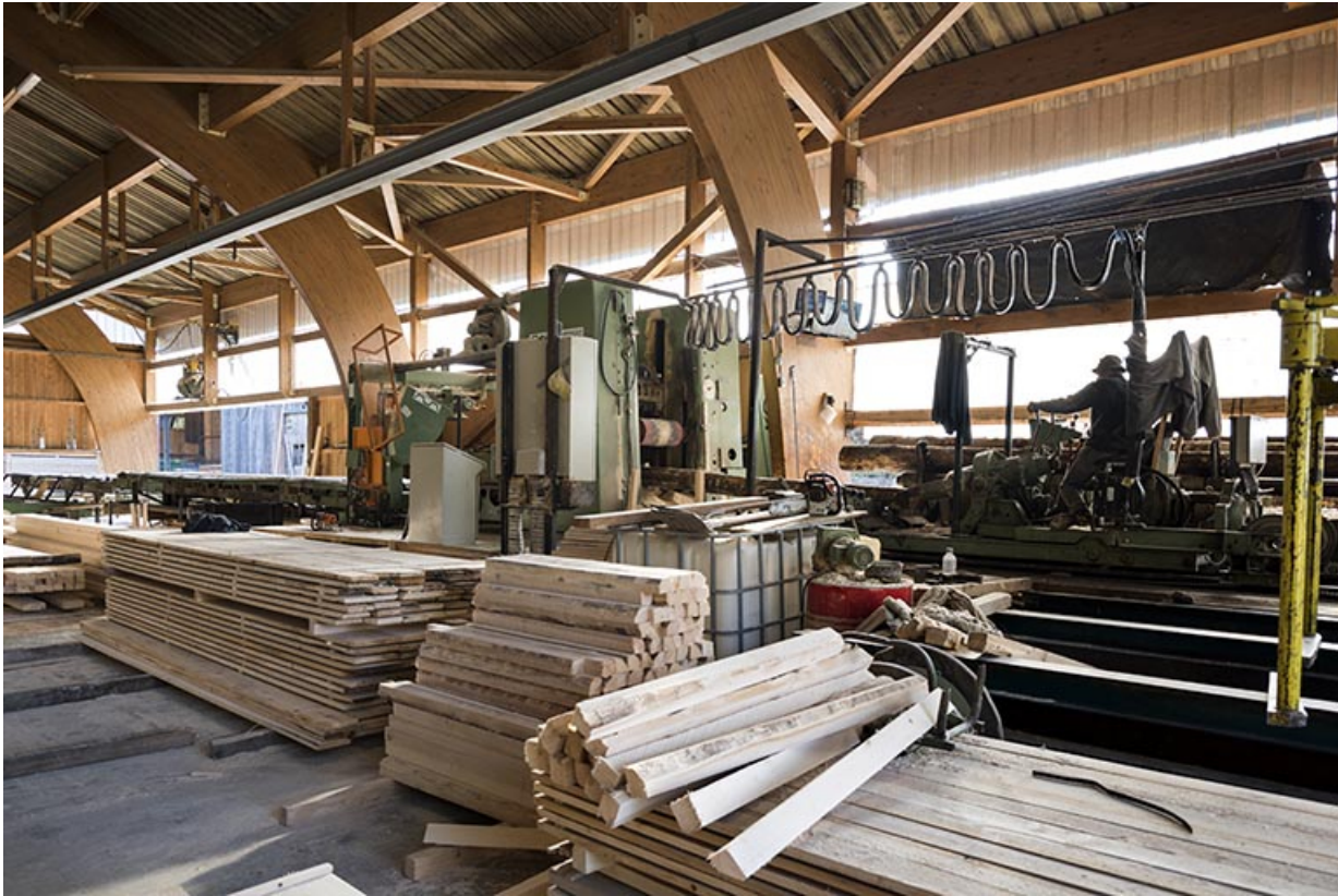
Atelier de fabrication (2000) : châssis multiple Möhringer.
