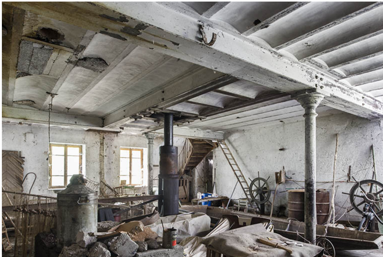
Rez-de-chaussée de l'atelier de fabrication. Au centre, arbre de la turbine.
